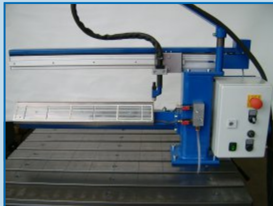
Soldadura de juntas de esquina en viga en vacío
