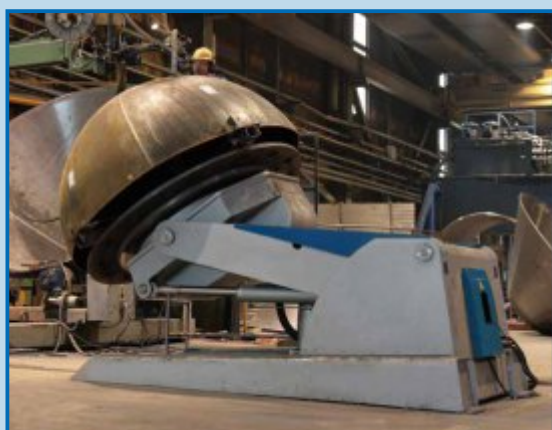
Dispositivos de rotación - Posicionadores con función de levantamiento, inclinación y rotación hasta 250 t
