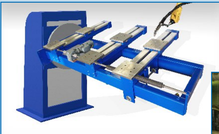
Montaje de soldadura de marcos para aplicaciones de robótica
