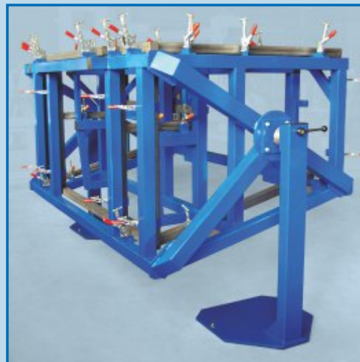
Plantillas de soldadura para componentes 3D grandes
